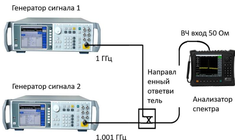
Рис.1 Подключение системы измерения ИМискажений третьего порядка
