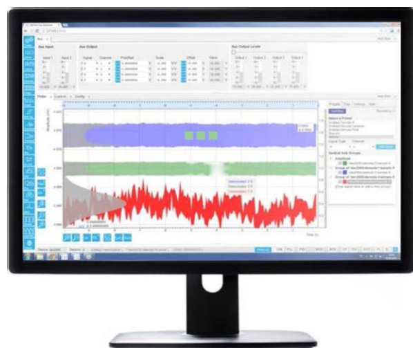
Рис.15. Пользовательский интерфейс LabOne® синхронного усилителя UHF Lock-in Amplifier использует самую новую браузерную технологию. Прибор может управляться из нескольких сессий нескольких браузеров, работающих на нескольких компьютерах, планшетах и т.д. одновременно. Каждый инструмент анализа и контроля сигналов имеет специальную вкладку. Некоторые функциональные возможности интуитивно отображаются в виде блок-схем.
